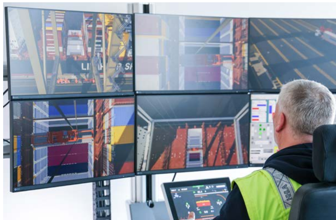
Auf dem HHLA-Containerterminal Altenwerder werden die ersten Containebrücken von einem Mitarbeiter ferngesteuert.
